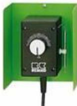
Влагонепроницаемый комнатный термостат, готовый к подключению, с мелкой градуировкой. Степень защиты IP 54, длина кабеля 10 м. Влагозащищенный кабель со штепселем, содержащий защитное устройство из окрашенного стального листа
